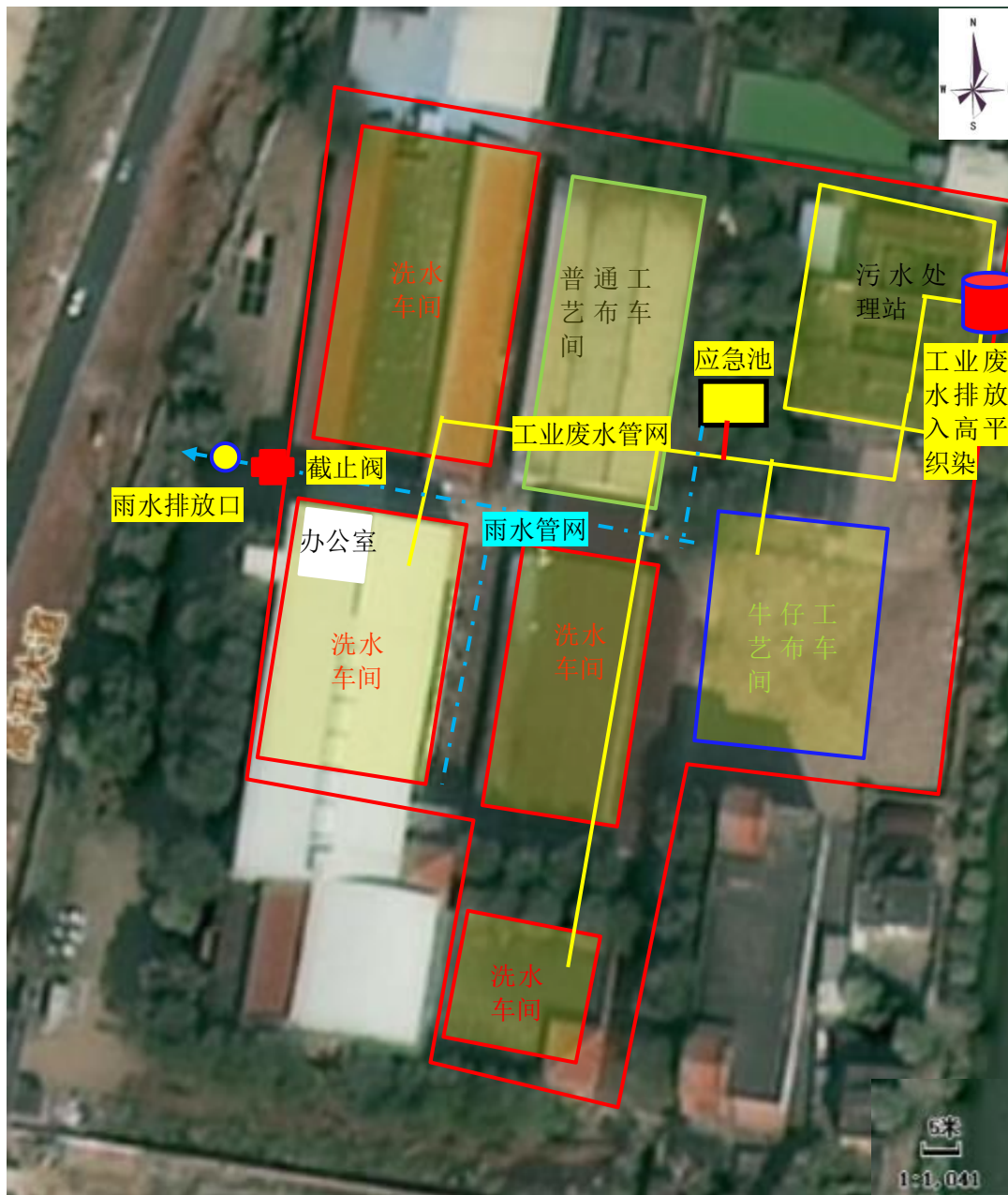
图 5-1 雨水与工业废水连接管网一览图
