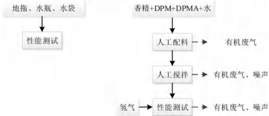
图2-7 实验室生产工艺流程及产污环节图
