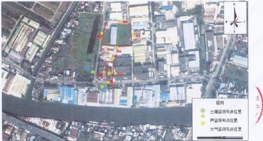
图 1 环境空气检测点位 (A1)、噪声检测点位 (N1-N8)、土壤检测点位 (S1、S2) 示意图
