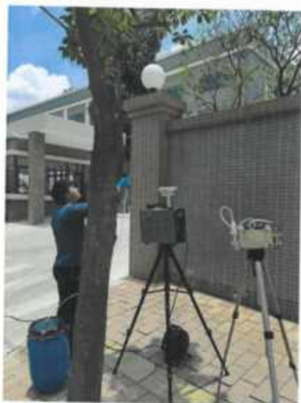
厂界废气下风向监控点3#
