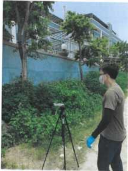
西北面厂界外1米处3#噪声检测点（昼间）
