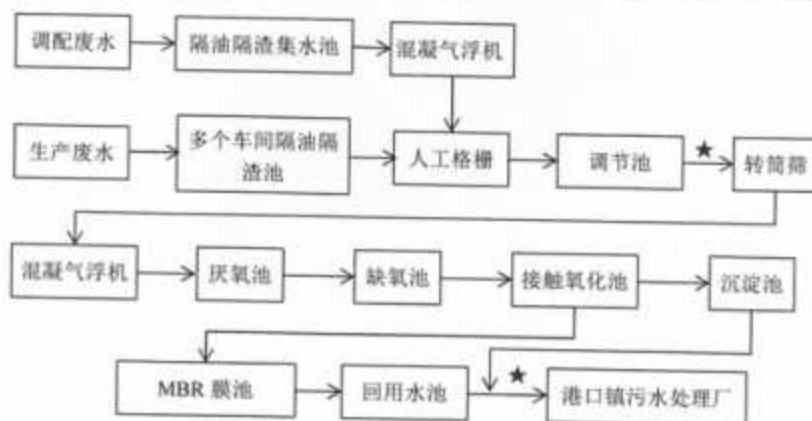
图 3-1 生产废水治理工艺流程图
