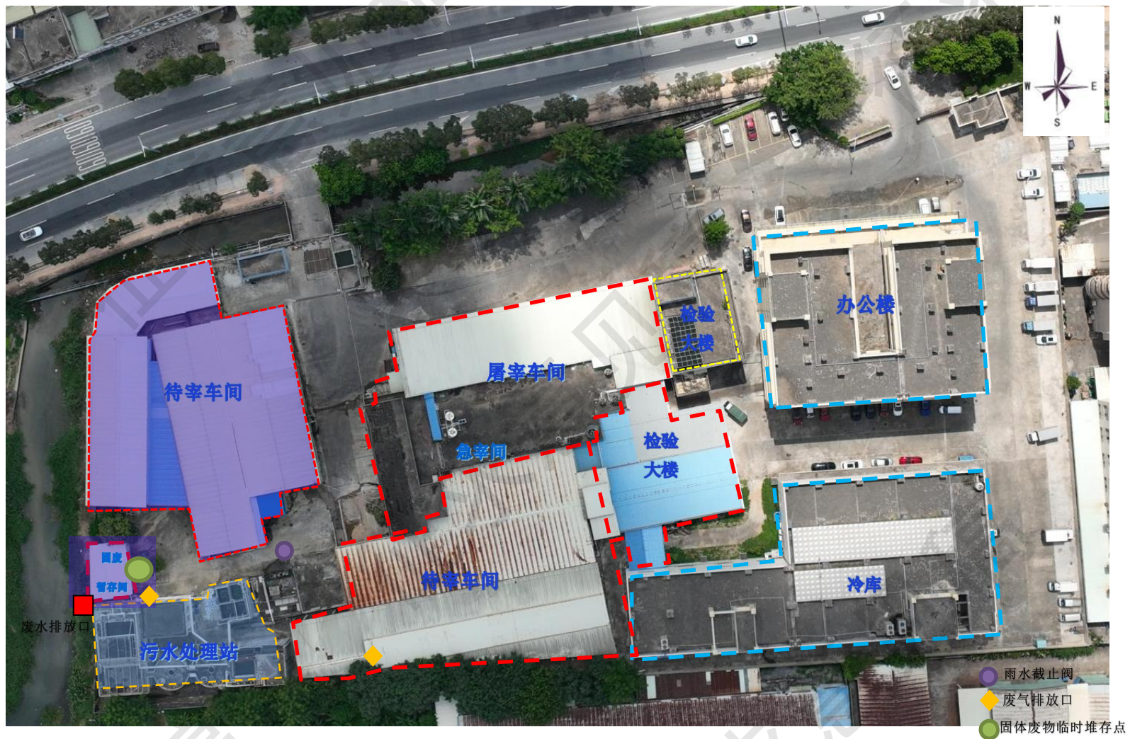
图 7-3 项目分区防渗图 (蓝色区域为重点防渗区域, 其余为一般区域)
