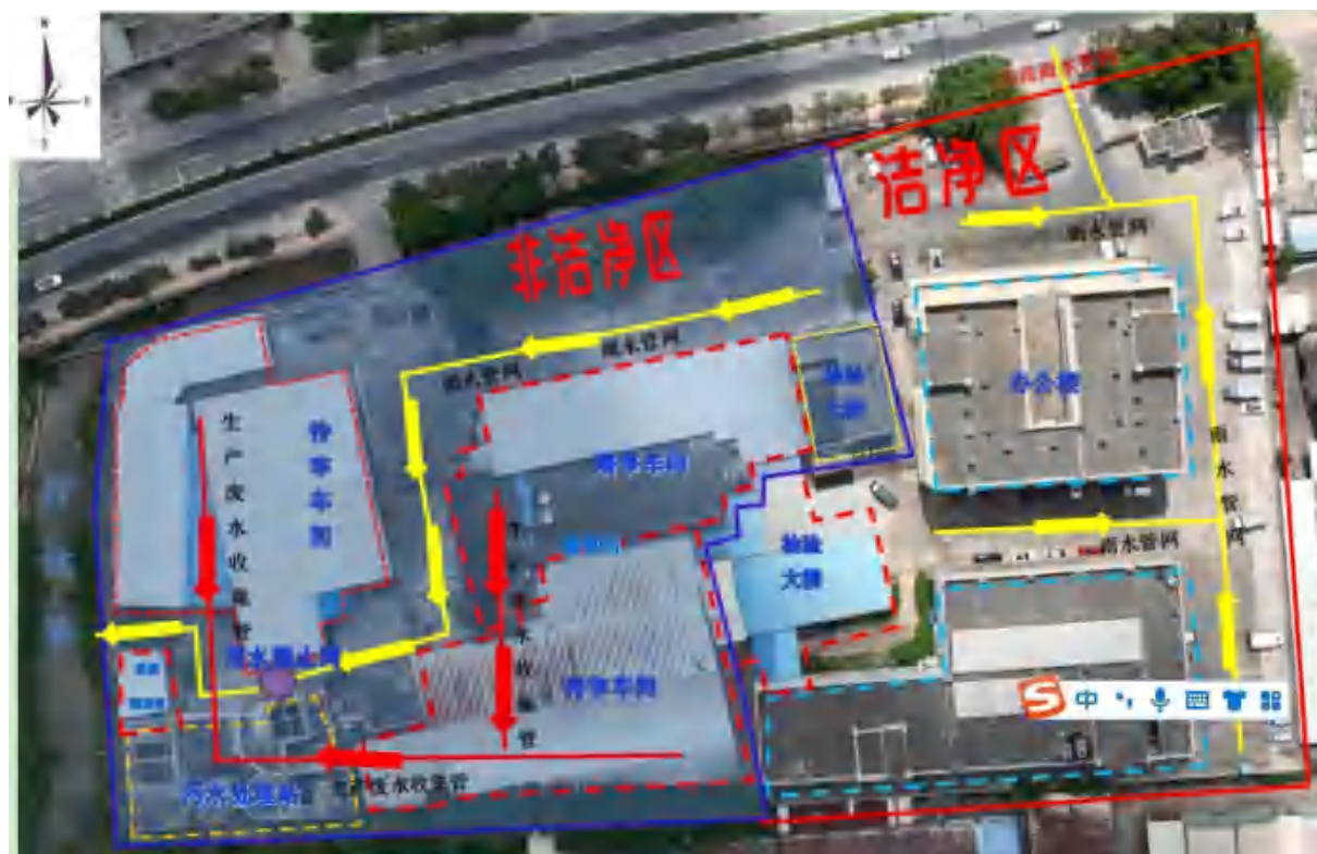
图 6-23 项目初期雨水、消防废水收集区（针对非洁净区收集）
