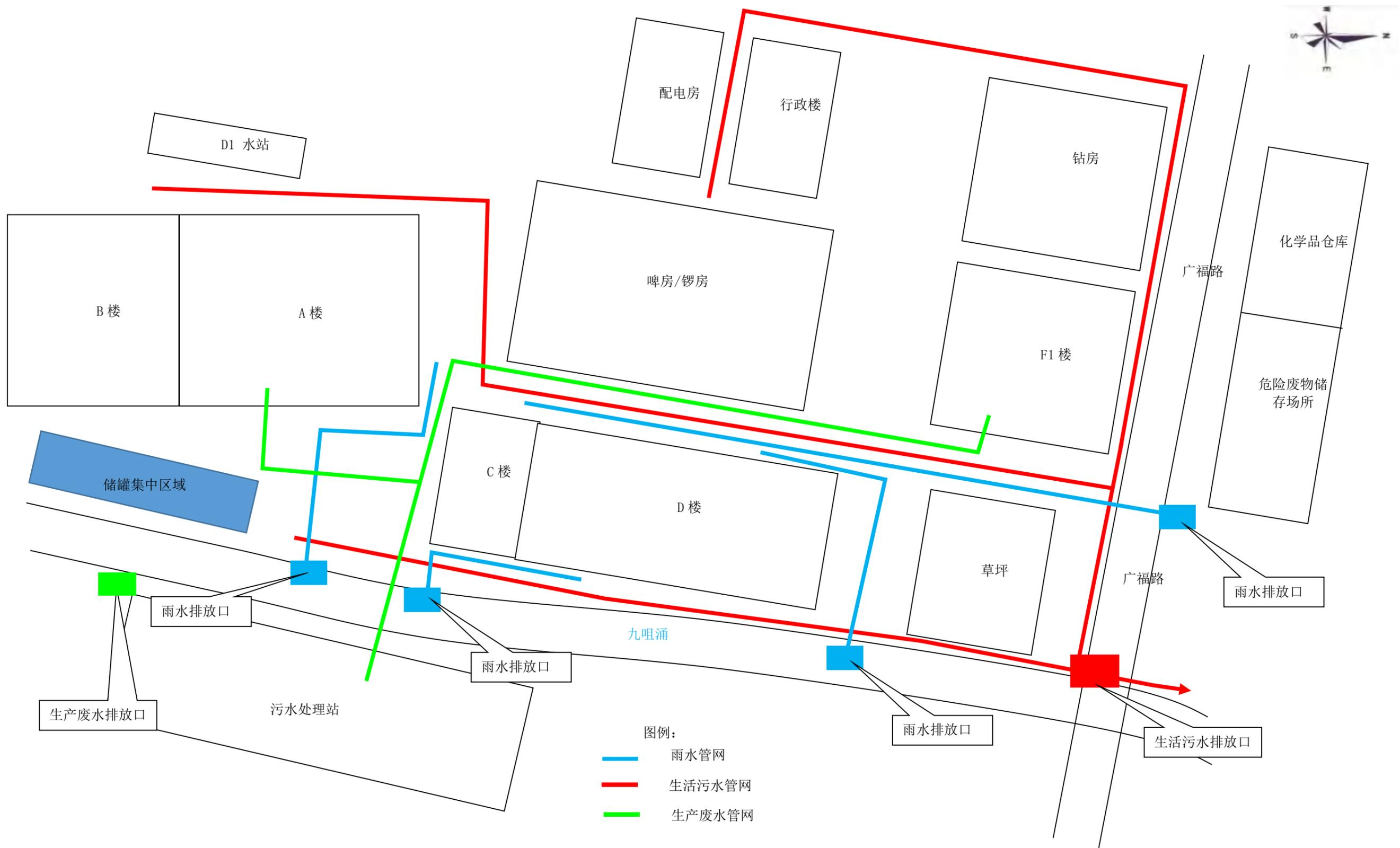
图 4-13 公司雨、原料管道管网分布
