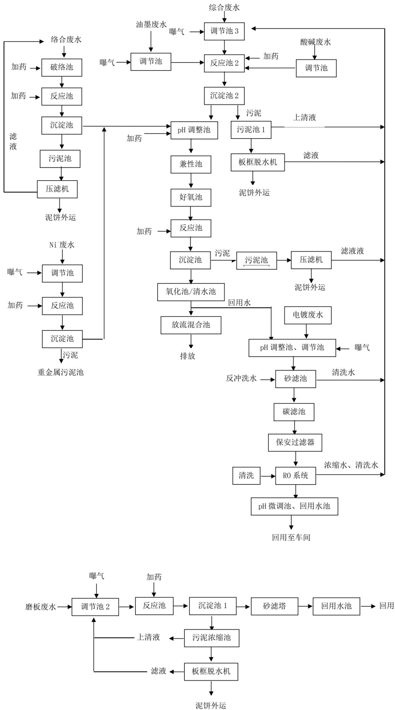
图4-4-1 一期废水工艺流程图
