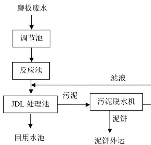
图 4-4-2 二期污水处理工艺流程图
