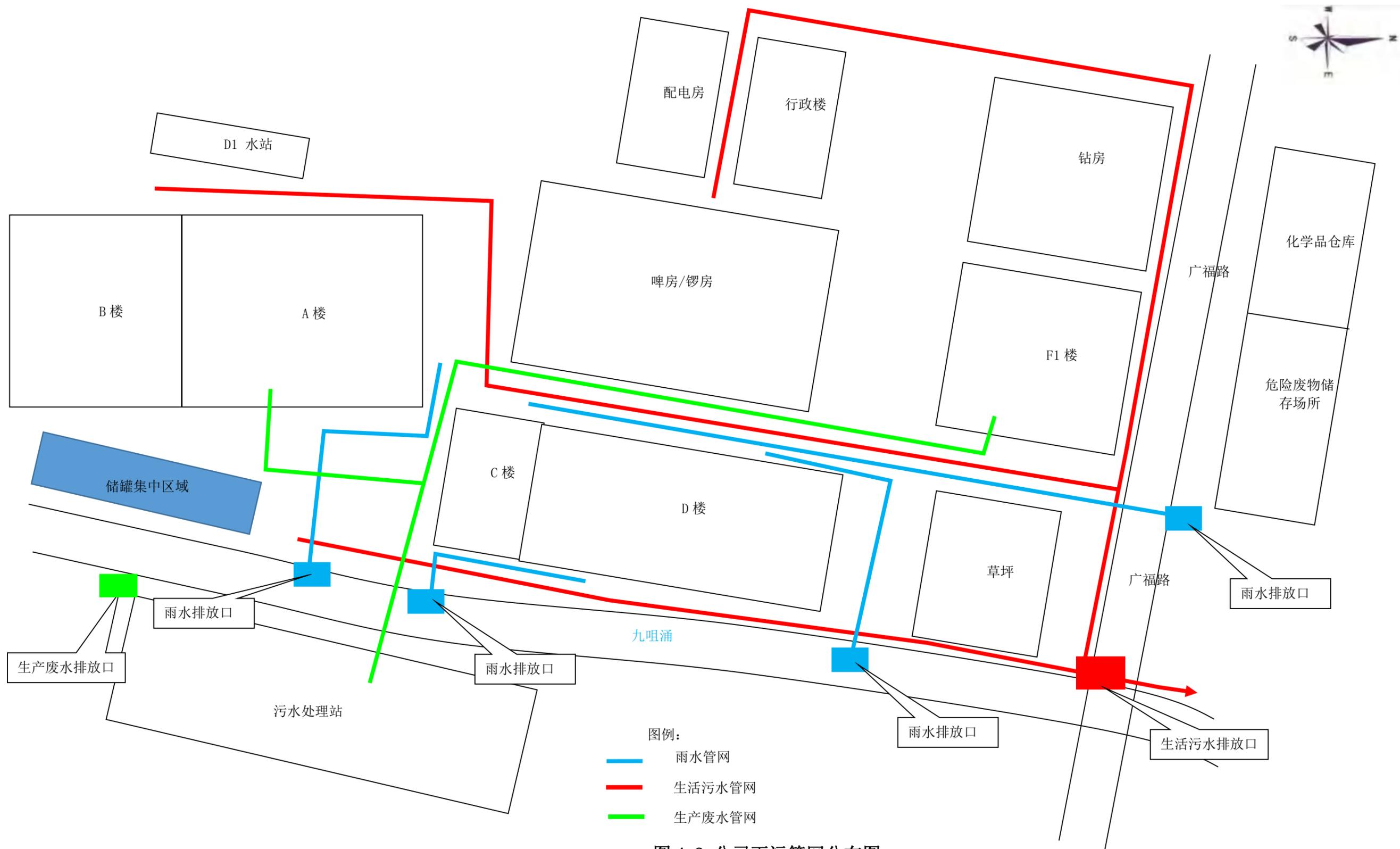
图 4-2 公司雨污管网分布图
